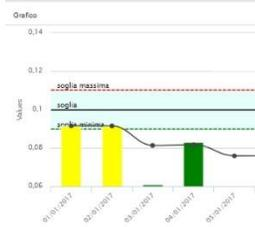
L'andamento target permette di relazionare due flussi dati di natura differente realizzando un indice prestazionale. L'indice viene mostrato attraverso un istogramma giornaliero, e viene integrato da una curva di andamento progressivo. È possibile integrare l'elemento inserendo una soglia limite con un grado di tolleranza
